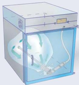
El sistema EOGas esteriliza y airea en la *misma cámara*. No necesita transferir productos a un área separada de aireación mientras hay liberación de gases.
